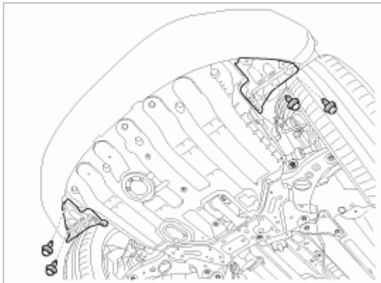
3. 拧下前保险杠侧固定螺钉后，分离侧面固定装置。
